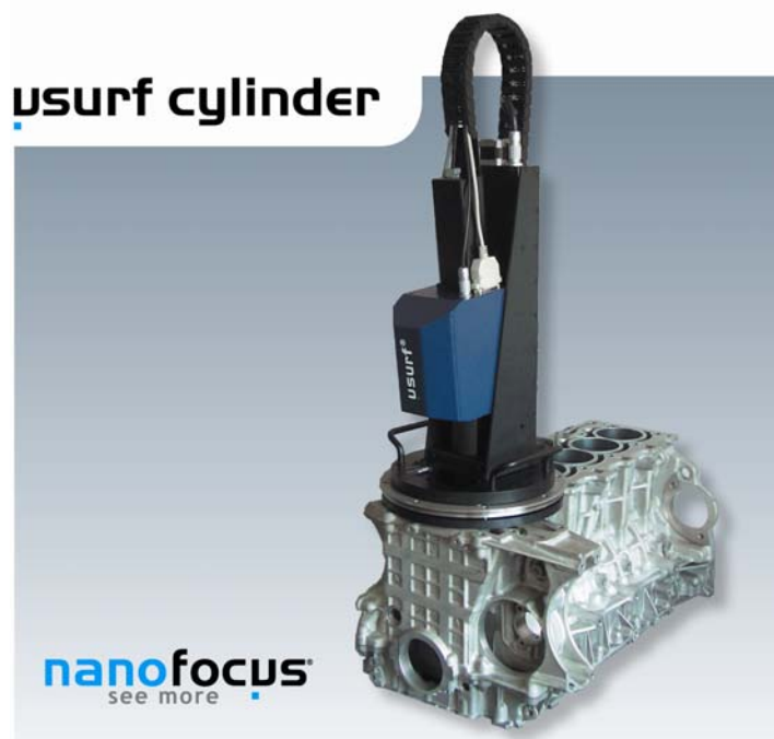
(Abb. 1: NanoFocus \mu surf cylinder zur Qualitätssicherung modernster Alusil-Motoren)
