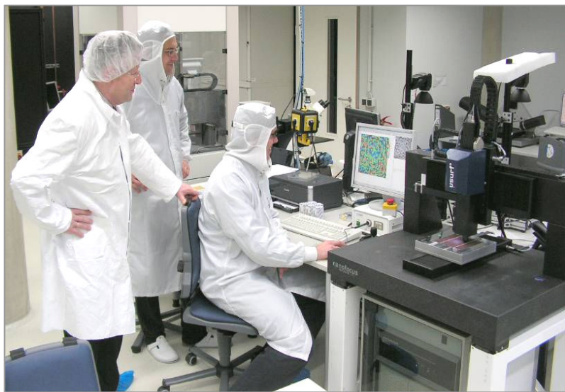
(Abb. 1: Die Experten von ISE und NanoFocus bei der Messung von Solarzellen mit dem Gerät \mu surf)
