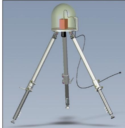
**Mobiles Sfs-Messsystem mit  $200 \times 200 \text{ mm}^2$  Messfeld.** Die wesentlichen Elemente sind die Kamera im Kopf und die LED-Gruppen an den unteren Enden der Stativbeine
