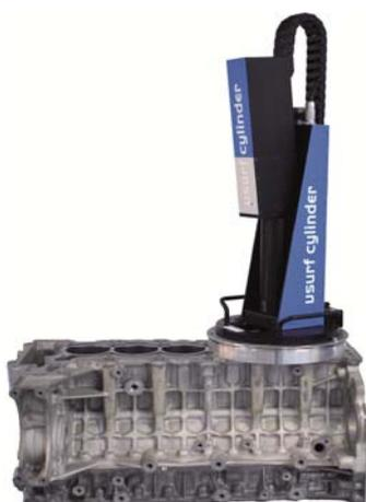
*Der  $\mu$ surf cylinder mit einer an die Geometrie des Zylinders angepasste Tauchführung mit gewinkelter Optik.*
