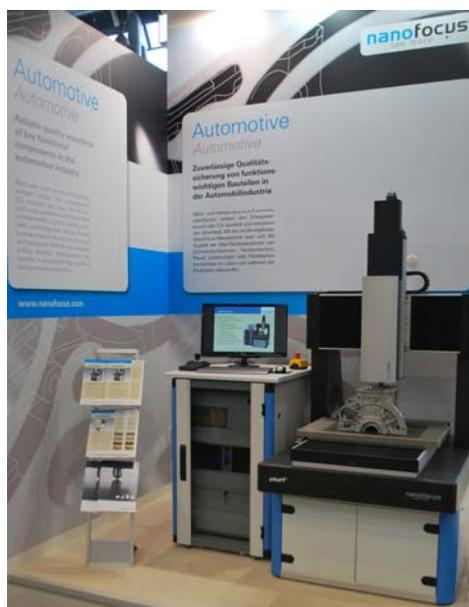
Bild 2: Eine der vorgestellten Innovationen war das erweiterte  $\mu$ surf custom, mit dem auch schwere und große Bauteile, wie hier ein Zylinderblock, vermessen werden können.
